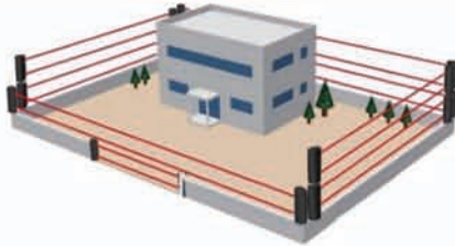
Photoelectric Beam Detector Diagram نمودار تشعشع پرتو الکتریکی
